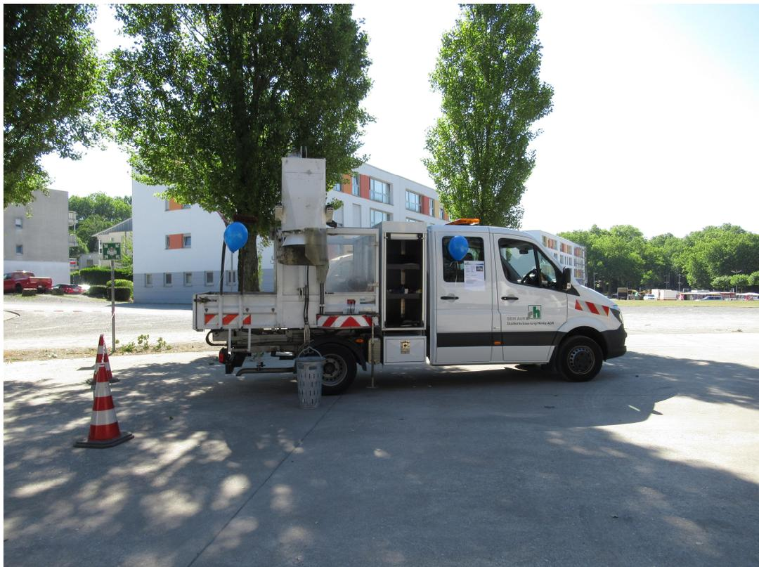
Abbildung 15: Sinkkastenfahrzeug der SEH
