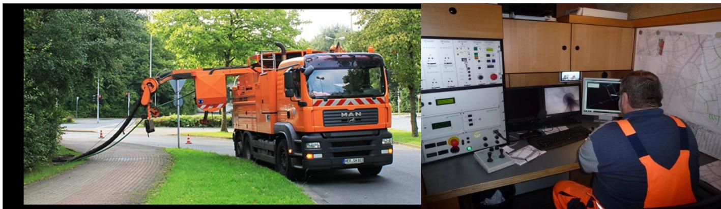
Abbildung 4: Saug- und Spülfahrzeug und TV-Inspektionsfahrzeug
